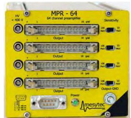
**Abb. 4.5:** Mesytec Vorverstärker MPR64
